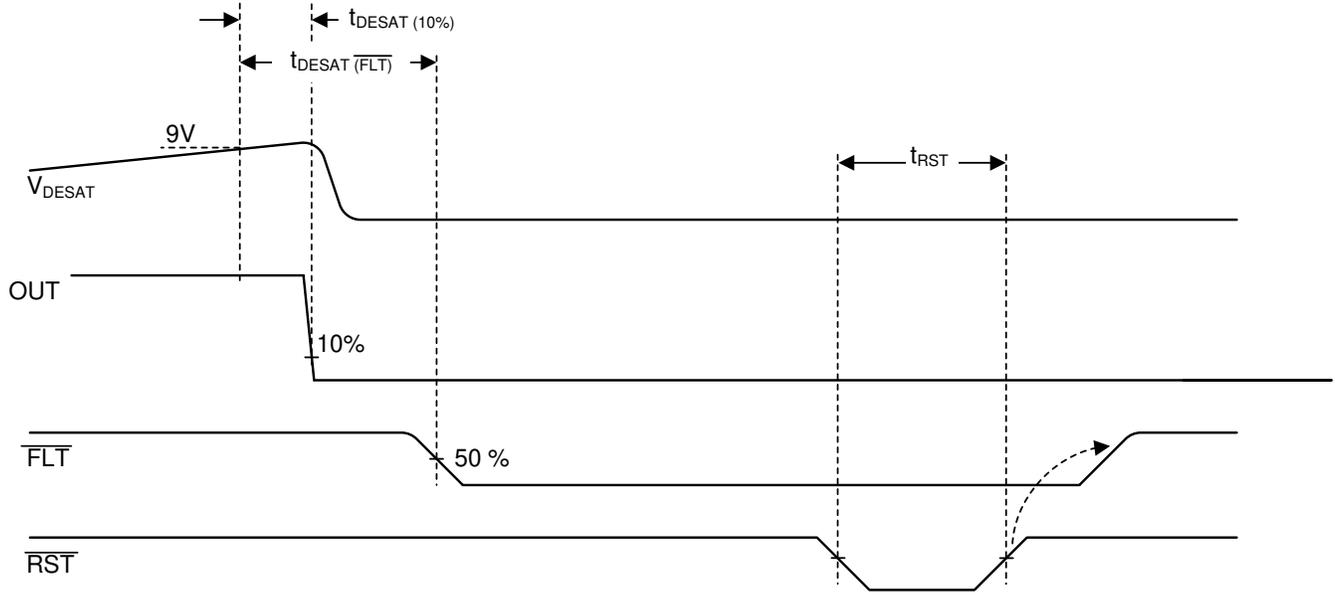
Figure 8-3. DESAT, OUT,  $\overline{FLT}$ ,  $\overline{RST}$  Delay
