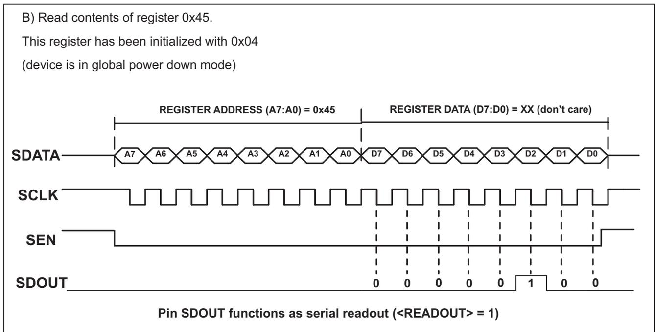
Figure 7. Serial Readout
