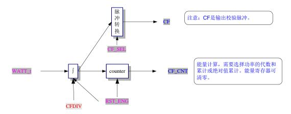
有功功率通过一段时间的积分,可获得这段时间有功能量,并进一步把能量 转化成对应频率校验脉冲 CF, 用电多, CF 频率就快, 用电少, CF 频率就慢。
