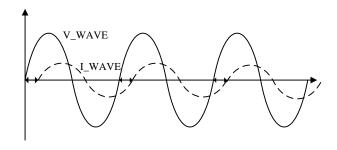
通过计算电流和电压的正向过零之间的时间差得到相位差,对应时间值更新 到寄存器 ANGLE,寄存器是 16 位无符号数。
