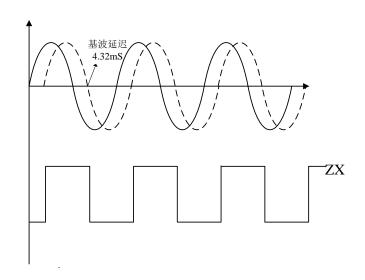
注意: 为防止底噪信号或小信号存在的杂散信号带来的不确定性, 电流过零阈值为 70000, 电压过零阈值为 200000. 如果瞬时有效值比阈值小, 无 ZX 信号。
