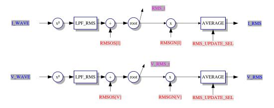
通道的原始波形,经过平方电路( $X^2$ )、有效值低通滤波器(LPF\_RMS)、 开根电路 (ROOT),得到有效值的瞬时值  $RMS_t$ ,再经过平均得到平均值  $I_RMS$ 和  $V_RMS$ 。
