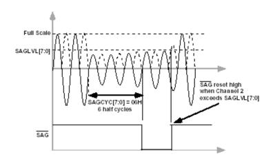
如上图所示,当电压有效值小于跌落电压阈值寄存器(SAGLVL)中设定的阈值并且跌落时间超过跌落线周期寄存器(SAGCYC)中的设定时间(图示为超过第 6 个半周期后,SAGCC[11:0]=06H),线电压跌落事件通过设置中断状态STATUS1 寄存器中的 SAG 标志位来记录下来。
