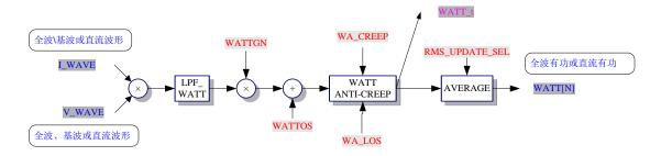
电流和电压波形通过数字乘法,然后依顺序经过低通滤波器、增益和偏差校准、防潜动判断及平均处理后可以获得功率信号。
