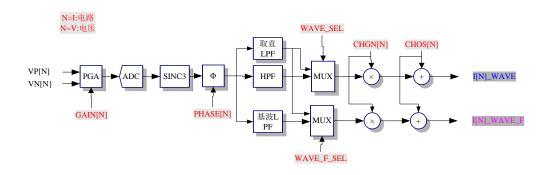
如上图,由两路相同结构的高精度的 ADC,采用双端差分信号输入:电流通道和电压通道分别输入的正负电压信号为 IP、IN 和 VP、VN。
